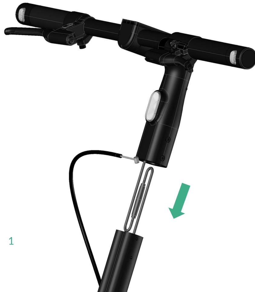
1. Führen die verbundenen Kabel in das Lenkrohr und setze dann den Lenkkopf wieder auf das Lenkrohr (siehe Bild 1).
