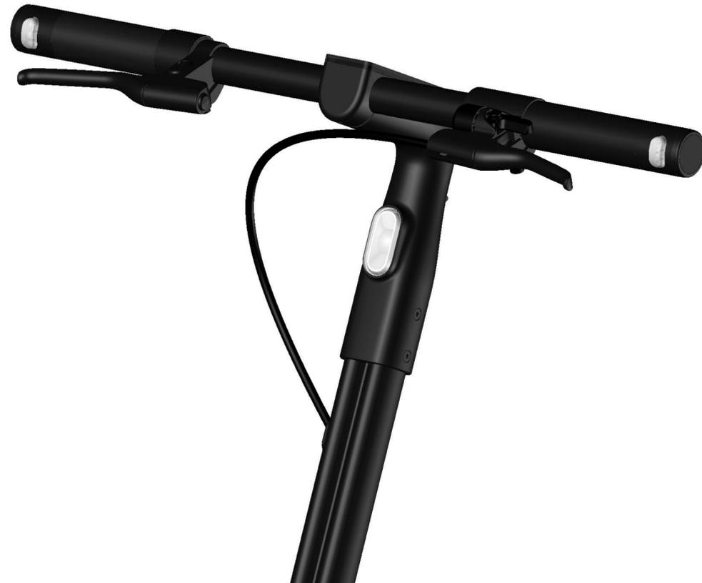
1. Wenn das Display, die Blinker, der Gas- oder Bremshebel defekt sind, wird zur Vereinfachung gleich die gesamte Lenker-Baugruppe getauscht.
